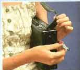
Abnehmen des Tragegurts bei Signal 500 und 700: Kugelschreiber in seitliches Loch drücken, Gurt herausziehen.
