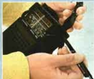
Abnehmen des Tragegurtes beim Signal 100: Kugelschreiber in senkliches Loch drücken, Gurt herausziehen
